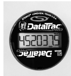
La modalidad TRIP muestra el kilometraje con decimales y el icono TRIP.
