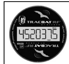
La modalidad TRIP muestra el kilometraje con decimales y el icono TRIP.
