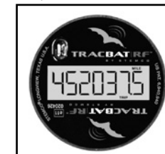
Le mode TRIP affiche le kilométrage avec les dixièmes et l'icône TRIP.
