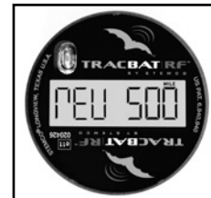
La modalidad REV muestra RPM o RPK para la cual la unidad ha sido programada.
